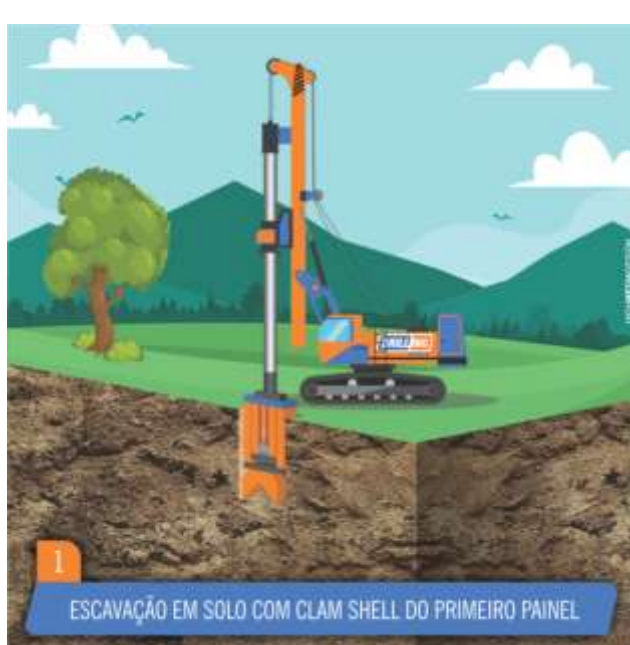
ESCAVAÇÃO EM SOLO COM CLAM SHELL DO PRIMEIRO PAINEL
