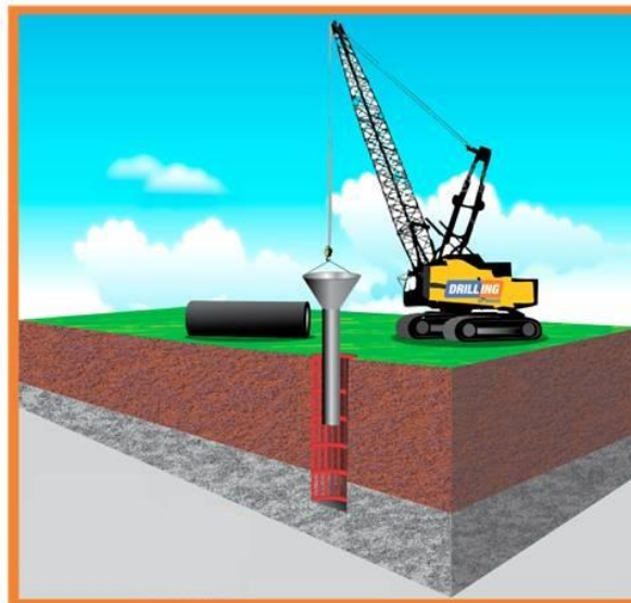
Colocação do tubo de concretagem.
