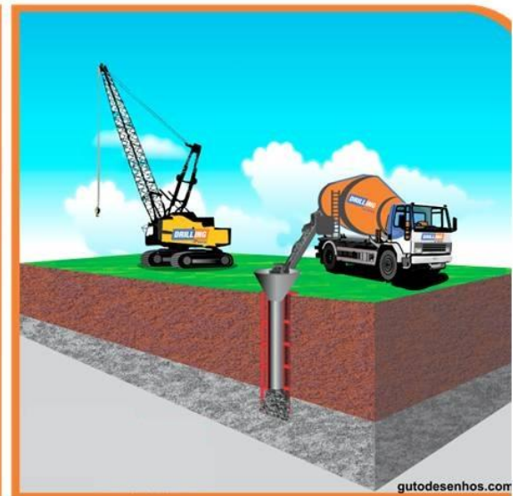
Execução da concretagem submersa ou a seco.
