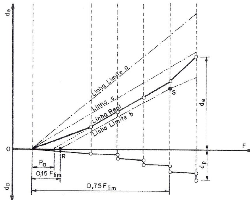
Figura A.3-b) - Repartição em deslocamentos elástico e permanente
